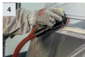
4 Vorbereitung für Lackauftrag Abralon K 2000
