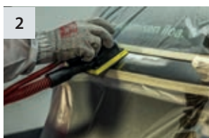
2 Spachtel ebnen und Übergänge schleifen OSP-3, OSP-4
