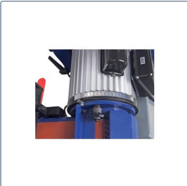
Schleifarmschwenkung über Klemmschraube und Skala von 0 - 90 °
