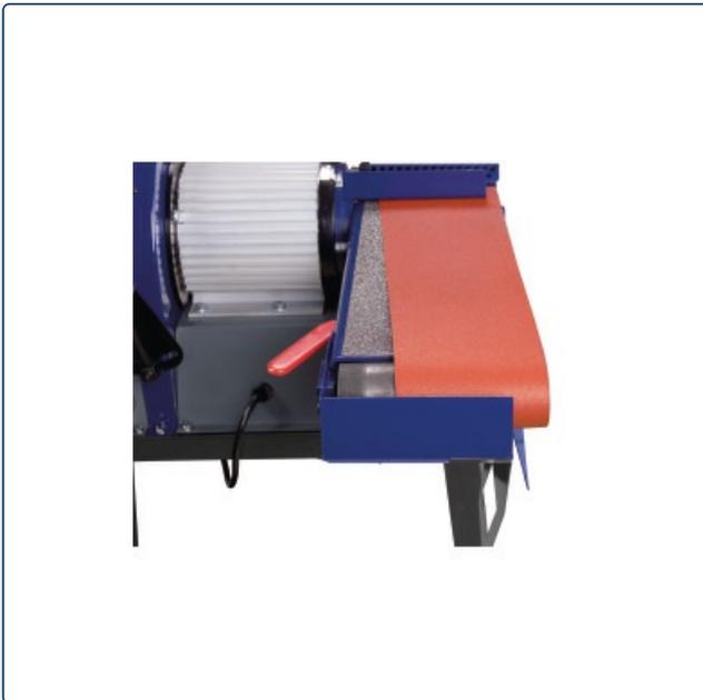
Graphitbelag auf der Schleifsohle erhöht die Gleiteigenschaft und die Lebensdauer des Schleifbandes
