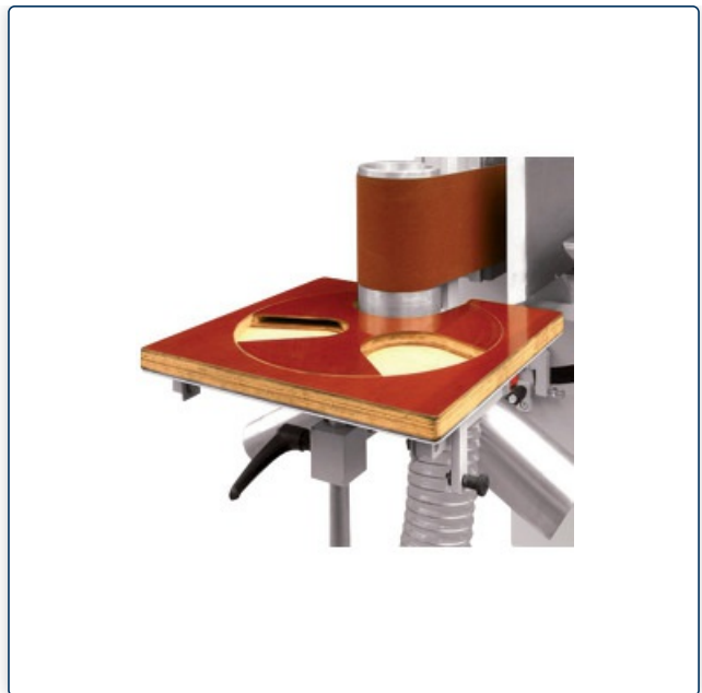
Drehstern und drehbare Absaugplatte zum schnellen Umrüsten auf die Schleifradien 60 mm, 100 mm und 120 mm
