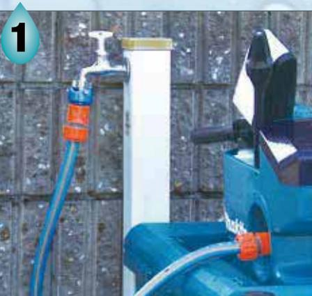
Wasserzufuhr von einem Hauswasseranschluss
